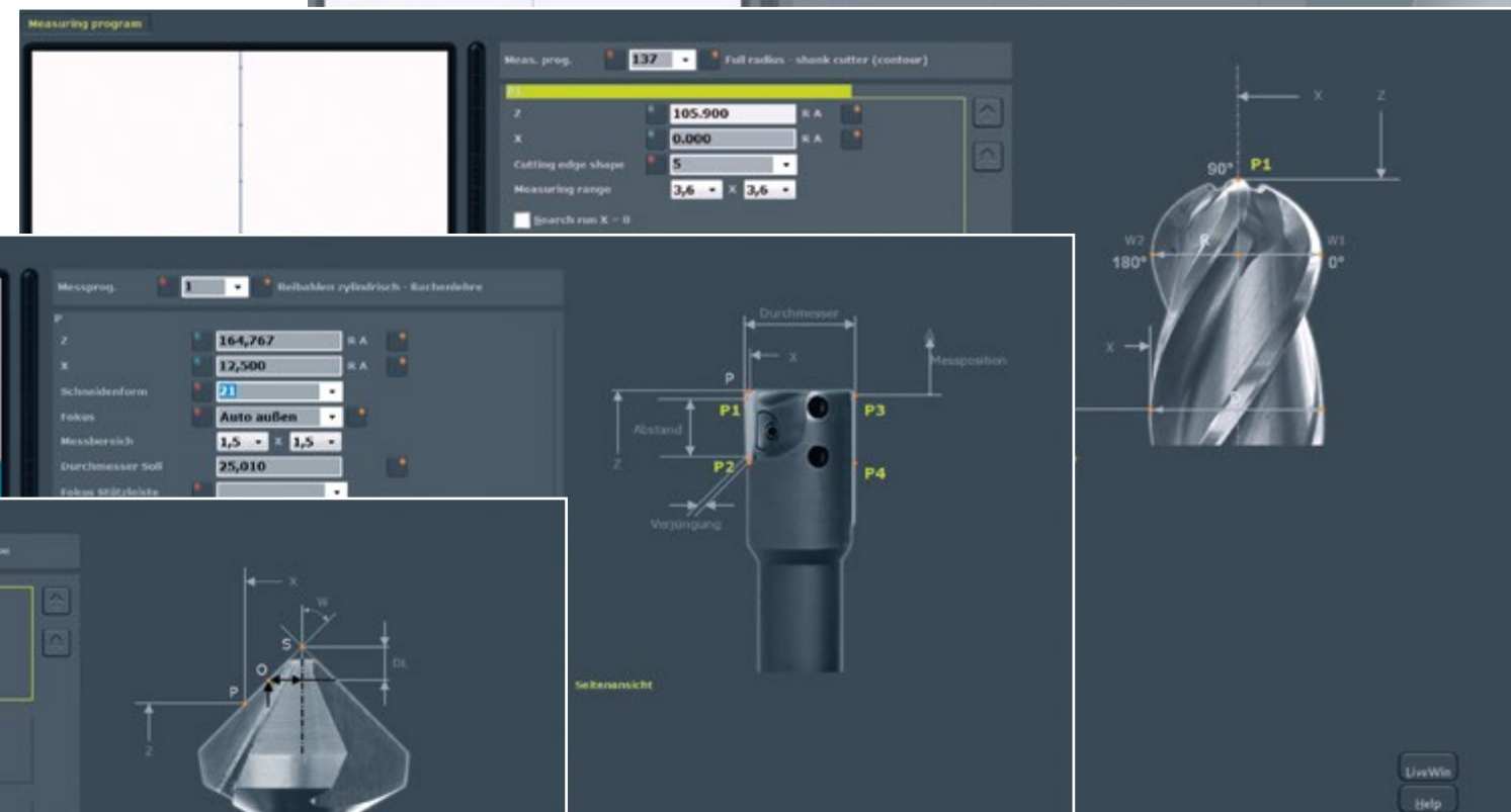
Programa de medición 137: para la determinación totalmente automática del contorno del radio.
